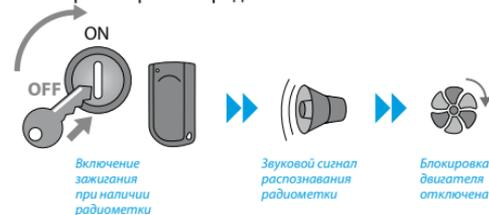
Если в момент включения зажигания радиометок нет в зоне действия радиосвязи, блок иммобилайзера активирует противоугонную функцию (заблокирует работу двигателя). Блокировка двигателя может осуществляться в зависимости от настроек, при включенной или выключенной функции датчика движения.
