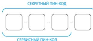
**Секретный ПИН-код** - заводское значение 1-1-1-1. Применяется для дополнительной авторизации при соединении иммобилайзера с мобильным приложением (Pandect BT) или для подтверждения изменённых параметров иммобилайзера через настройки приложения. «Се-
