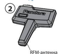
Рекомендуется располагать RF-модуль на лобовом стекле. При этом обеспечить расстояние от металлических частей кузова до RFM-антенн не менее 7 см. Учтите, что наличие встроенного обогрева лобового стекла может снизить дальность работы радиоканала.
