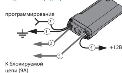
**Провод «1»** (Черный) реле блокировки должен быть присоединен к кузову автомобиля или надежному проводнику, соединяющему кузов и какой-либо штатный потребитель. Данный провод подсоединяется при монтаже в первую очередь.
