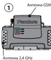
Рекомендуется располагать базовый блок системы под «торпедой» или в районе приборной панели разъемами вниз. При этом обеспечьте жесткое крепление к кузову автомобиля или деталям непосредственно связанным с кузовом. Встроенная GSM и 2,4 GHz-антенны не должна экранироваться металлическими элементами конструкции автомобиля. В случае если место установки не обеспечивает устойчивого приема сигнала сотовой сети, необходимо использовать внешнюю GSM-антенну.
