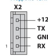
Данный разъем предназначен для цифрового управления дополнительными устройствами, например бесключевыми обходчиками штатных иммобилайзеров.
